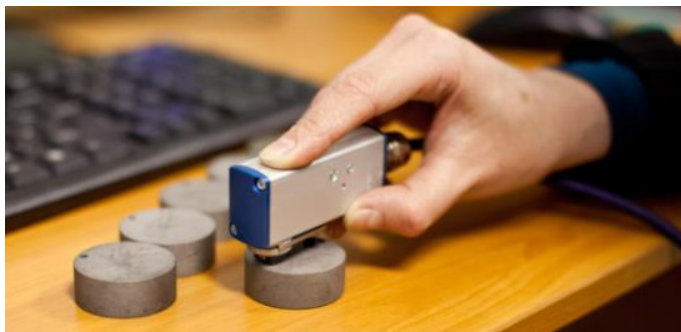
Исследование образцов быстрорежущей стали анализатором шумов Баркгаузена «Rollscan 300»
