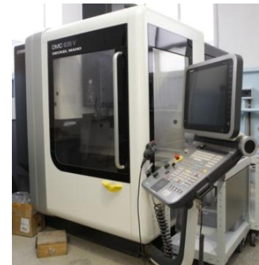
Фрезерный обрабатывающий центр DMC635V
