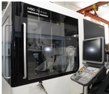
Фрезерный обрабатывающий центр HSC75V linear
