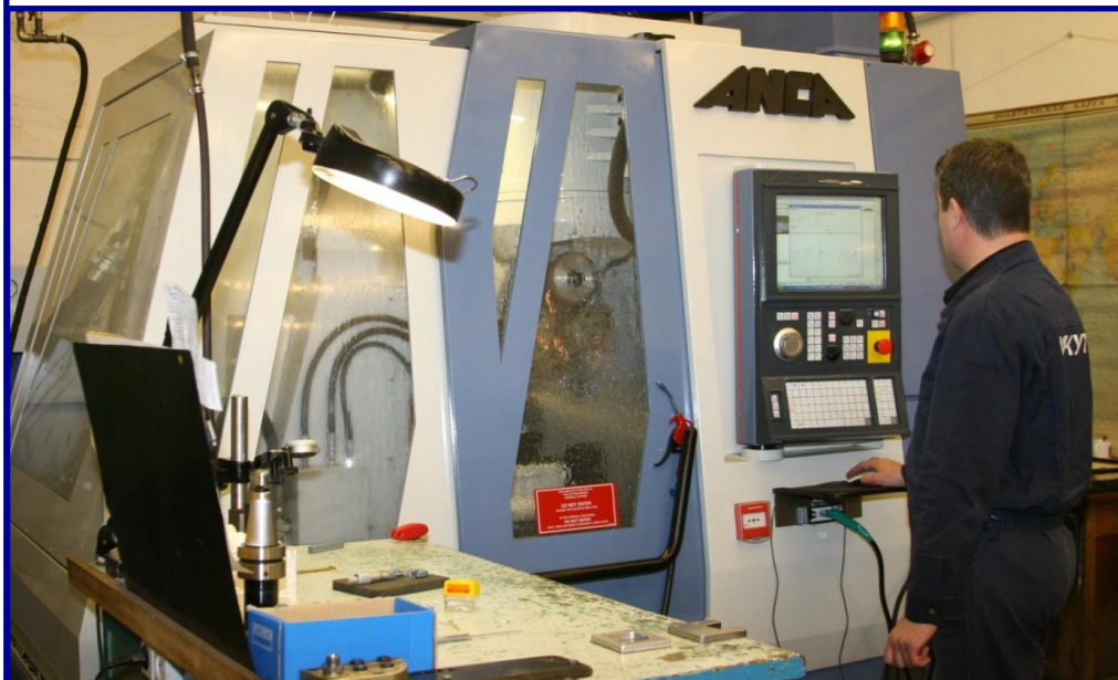
Шлифовально-заточной станок ANCA TX7
