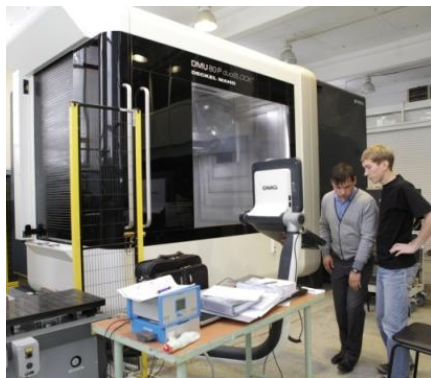
Фрезерный обрабатывающий центр DMU80P duoBlock
