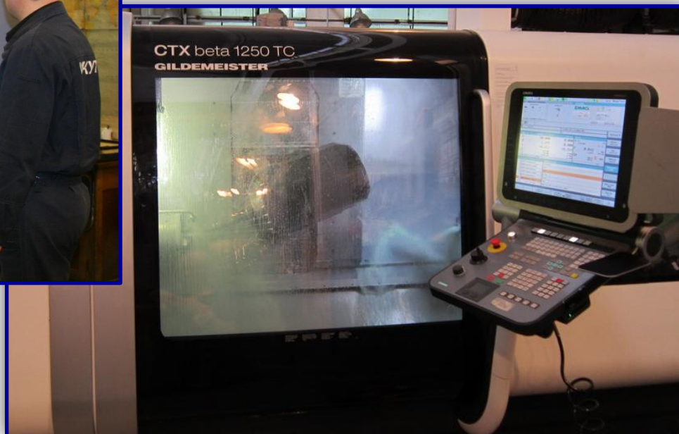
Токарно-фрезерный станок CTX Beta 1250 TC
