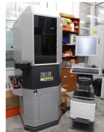
Прибор для измерения инструмента Zoller Genius III
