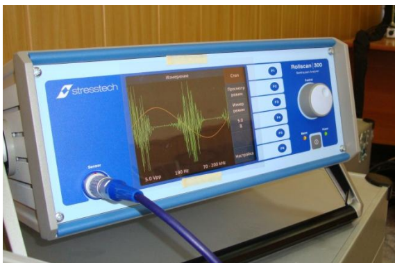
Цифровой анализатор шумов Баркгаузена Rollscan 300
