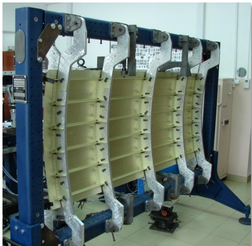
Лабораторные стелы для узловой и агрегатной сборки и стыковки изделий авиационной техники
