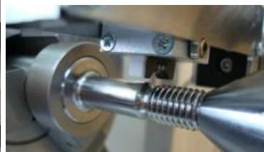
Измерение ОН в галтелях и канавках стыковочных болтов из стали 13X15H4AM3-Ш после деформационного упрочнения методом обкатки
