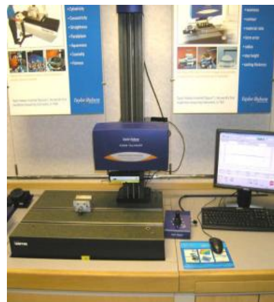
Прибор для измерения шероховатости Taylor Hobson Form
