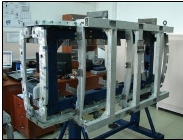
Лабораторные стелы для узловой и агрегатной сборки и стыковки изделий авиационной техники
