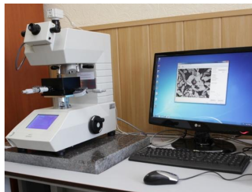
Микротвердомер Shimadzu HNV-2T
