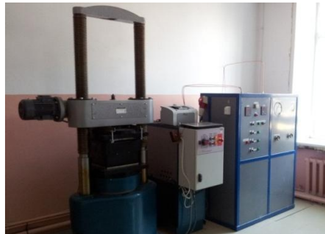
Испытательный пресс ИИ-1250м
