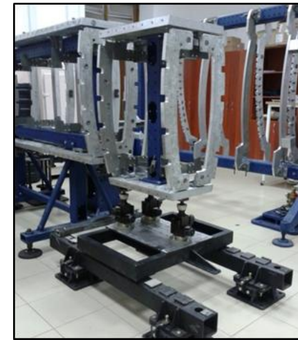
Лабораторные стелы для узловой и агрегатной сборки и стыковки изделий авиационной техники
